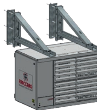
* Staffe sostegno superiore (solo alcune versioni) Suspended mode installation (some models only)
