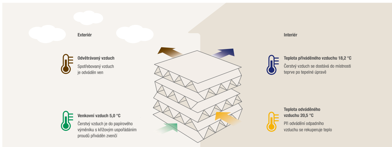
Struktura papírového výměníku s křížovým uspořádáním proudů
